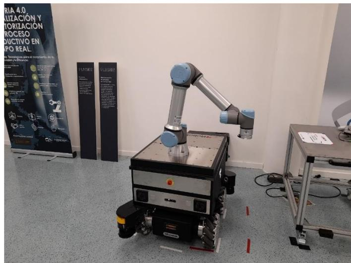
Ejemplo de robot ejecutando una trayectoria de lijado.
